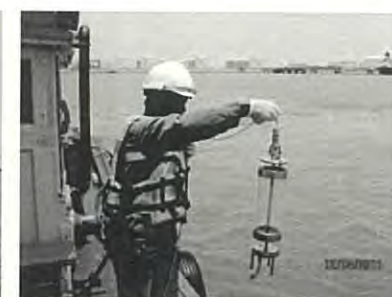
รูปที่ 2-1 การเก็บตัวอย่างน้ำทะเลด้วยเครื่องมือเก็บน้ำตัวอย่างน้ำทะเล (Kemmerer Sampler)
